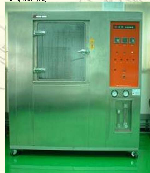
耐雨水及高壓水柱衝擊試驗機
