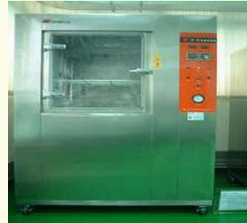
耐雨水及高壓水柱衝擊試驗機
